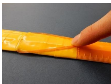
※4：ものさしに付けたゴムの様子(伸ばさない状態で基点0に合うように調整)
